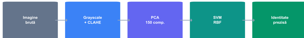
Figura 5: Arhitectura completă a sistemului de recunoaștere facială
